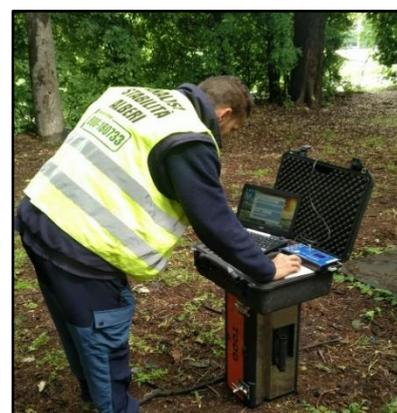
La **Fase 1** consiste nel sottoporre l'albero a una trazione semi-statica controllata, per mezzo di un paranco manuale collegato ad un punto di ancoraggio fisso. Al fine di non danneggiare la capacità di resistenza meccanica dell'albero, la sollecitazione esercitata viene comunque sempre contenuta entro limiti di sicurezza prefissati.
